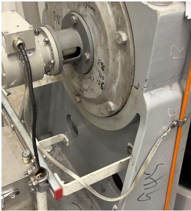
Abbildung 12: Anschluss des Erdungsbands an einen Erdungspunkt
