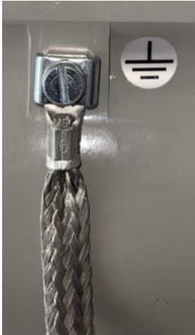
Abbildung 5: Fest angeschlossenes Erdungsband am Basisgerät USL 42
