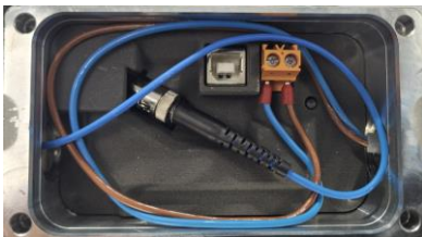
Abbildung 11: LWL-Kabel und Versorgungskabel im Klemmkasten des Basisgeräts USL(H) 42
