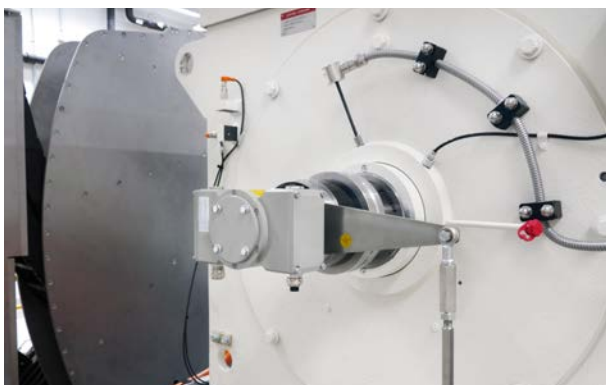
Grenzdrehzahlswitcher EGSHJ 41 von Hübner Giessen inklusive zertifiziertem Hohlwellenanbau zur sicheren Überwachung der Drehzahl am Prüfstandsmotor.
