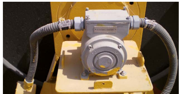
巻胴 ( ドラム ) に設置されたU-ONE®多回転基本ユニット U-ONE® Multiturn basic unit installed at rope drum
