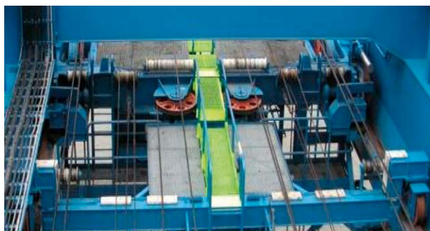
ロープ巻き取り駆動装置付トロリ Trolley with rope winch drive
