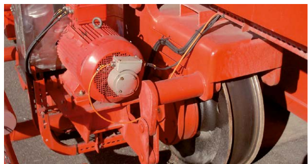
インクリメンタル・エンコーダ FG(H) 40L：モーター取付 Incremental encoder FG(H) 40L mounted to the motor
