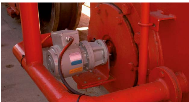
位置決め用U-ONE®基本ユニット：非駆動輪取付 U-ONE® basic unit for positioning mounted to non-driven wheel
