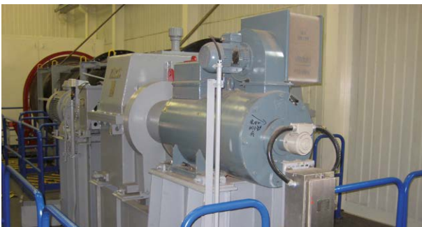
モーターに取り付けてあるインクリメンタル・エンコーダ FG(H) 40 L Motor with mounted incremental encoder FG(H) 40 L
