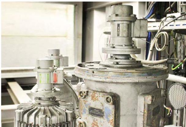
Vorher: Drehzahlerfassung mit analogen Tachogeneratoren.
