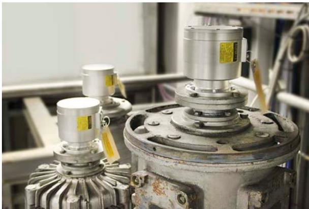
Nachher: Inkrementale Drehgeber ermöglichen digitale Drehzahlregelung.
