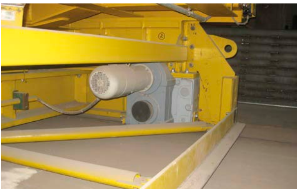
Batterie-betriebener und robuster Gleichstrom-Nebenschluss-Motor GN 17.174 für störungsfreien Betrieb ohne Schleppkabel.
