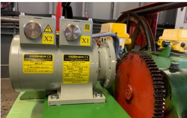
Nachher: U-ONE-SAFETY-Compact (USC 42) mit 6 sicherheitszertifizierten Positionsschaltern (SIL 2 / PL d).
