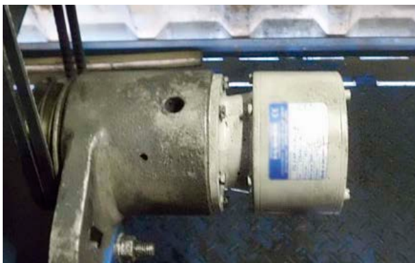
Nachher: Deutlich präzisere Drehzahlüberwachung durch den inkrementalen Drehgeber FG 2 mit integriertem elektronischen Grenzdrehzahlschalter.
