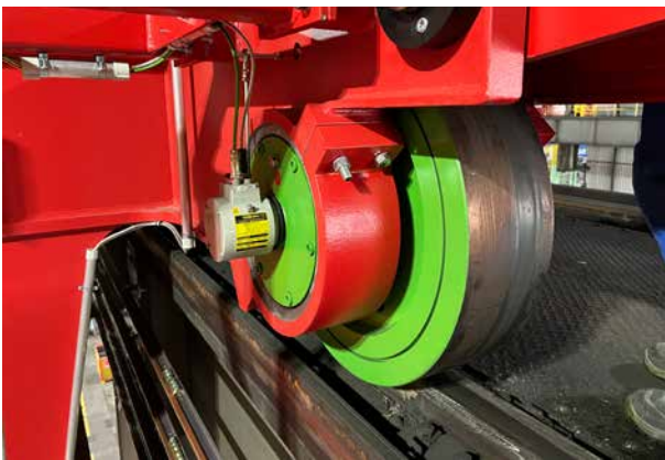
Absolutwertgeber AMPNH 41 am Fahrwerk.
