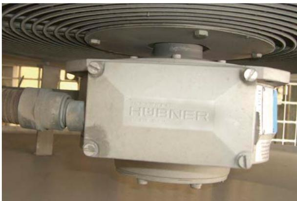
Inkrementaler Drehgeber FGHJ 5 mit speziellen Hybridlagern im Heavy-Duty-Gehäuse.
