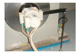
使用法兰式适配轴和带有底板的扭矩支架将FGH 6与EGS 4安装在混凝土表面上。
