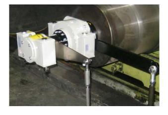
使用法兰式适配轴和扭矩支架将FGH6与EGS41 安装在一起。
