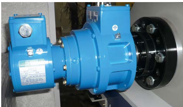
圧延機 / メインドライブ : 中空軸アブソリュートエンコーダASEH 60 (EtherCATインターフェース) と付属の電子式回転速度スイッチEGS 41 Rolling mill / Main drive : hollow shaft absolute encoder ASEH 60 (EtherCAT interface) and attached electronic overspeed switch EGS 41
