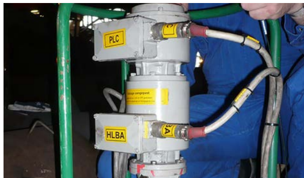
圧延機 / スクリュー式電動圧下装置 : アブソリュートエンコーダAMS (SSIインターフェースとインクリメンタル出力) および付属のアブソリュートエンコーダAMS (SSIインターフェース) Rolling mill / Screw downs : absolute encoder AMSI (SSI interface and incremental output) and attached absolute encoder AMS (SSI interface)
