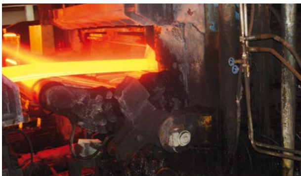
熱間圧延機/ルーパー：SSIインターフェースを備えたアブソリュートエン コーダALS特別な堅牢なルーパー設計 (例：軸受と強化された軸) Hot rolling mill / Looper: absolute encoder ALS with SSI interface in special robust looper design (e.g. bearings and shaft reinforced)
