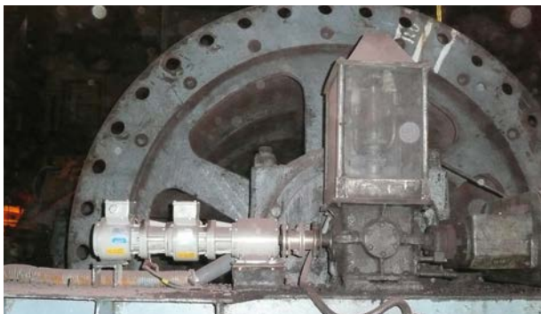
製鋼 / スキップカー : インクリメンタルエンコーダ付き軸受ブロック FG 40およびアブソリュートエンコーダAMS (SSIインターフェース) Steel making / Skip car : bearing block with incremental encoder FG 40 and absolute encoder AMS (SSI interface)
