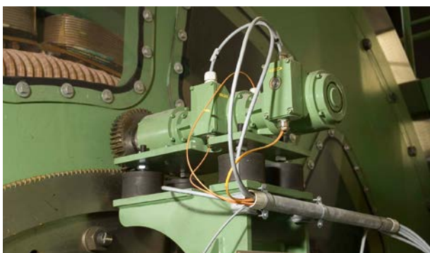
鉱産 / ワインダー : 冗長インクリメンタルエンコーダFG 40 KKおよびアブソリュートエンコーダAMN L (FOCを備えたDeviceNetインターフェース) 付き軸受ブロック接続 Mining / Winder : bearing block with redundant incremental encoder FG 40 KK and absolute encoder AMN L (DeviceNet interface with FOC connection)
