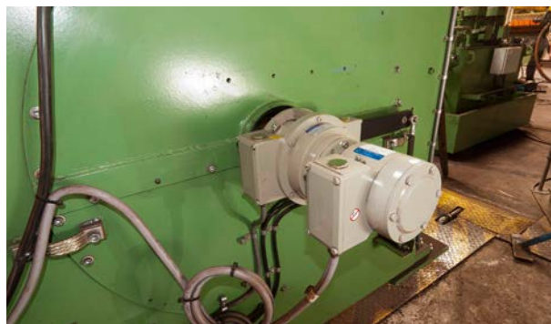
熱間圧延機/メインドライブ：中空軸アブソリュートエンコーダASPAH 60 (パラレルインターフェース) 付属の電子式回転速度スイッチEGS 40 Hot rolling mill / Main drive: hollow shaft absolute encoder ASPAH 60 (parallel interface) with attached electronic overspeed switch EGS 40
