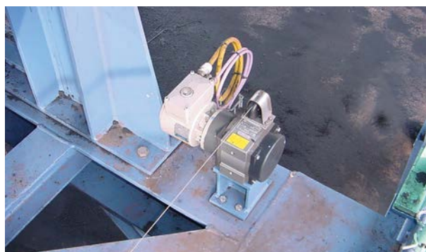
マテハン / ベルトコンベヤー : アブソリュートエンコーダAMP (PROFIBUSインターフェース) 付ロープ長トランスミッター Material handling / Conveyor belt : rope length transmitter with attached absolute encoder AMP (PROFIBUS interface)
