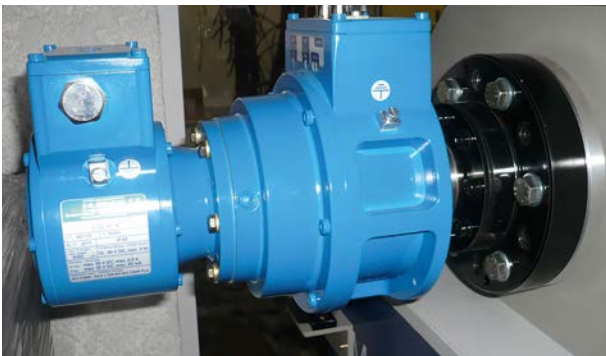
Trenes de laminación / accionamiento principal: encoder absoluto de eje hueco ASPAH 60 (interfaz EtherCAT) y conmutador de sobrevoluntad electrónico EGS 41 acoplado Rolling mill / Main drive: hollow shaft absolute encoder ASEH 60 (EtherCAT interface) and attached electronic overspeed switch EGS 41
