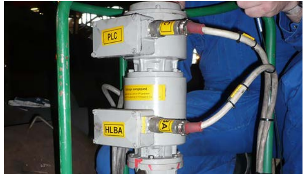
Trenes de laminación / ajustes: encoder absoluto AMSI (interfaz SSI y salida incremental) y encoder absoluto AMS acoplado (interfaz SSI) Rolling mill / Screw downs: absolute encoder AMSI (SSI interface and incremental output) and attached absolute encoder AMS (SSI interface)
