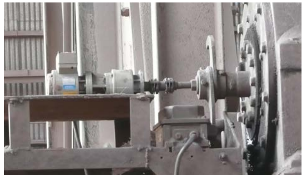
Tratamiento de material / volquete: bloque de rodamientos con absoluto acoplado encoder AMN (interfaz DeviceNet) Material handling / Wagon tippler: bearing block with attached absolute encoder AMN (DeviceNet interface)
