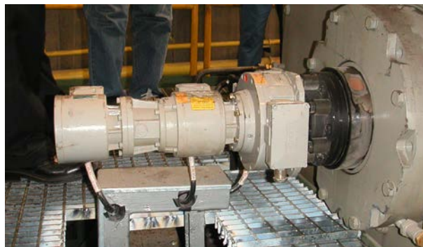
Trenes de laminación calientes / accionamiento principal: encoder incremental de eje hueco FGH 6, switch de sobrevelocidad electrónico EGS 40, y encoder absoluto AMS (interfaz SSI) Hot rolling mill / Main drive: hollow shaft incremental encoder FGH 6, electronic overspeed switch EGS 40 and absolute encoder AMS (SSI interface)
