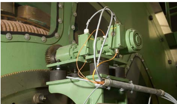
Minería / máquina extractora: bloque de rodamientos con encoder incremental redundante FG 40 KK y encoder absoluto AMN L (interfaz DeviceNet con conexión FOC) Mining / Winder: bearing block with redundant incremental encoder FG 40 KK and absolute encoder AMN L (DeviceNet interface with FOC connection)
