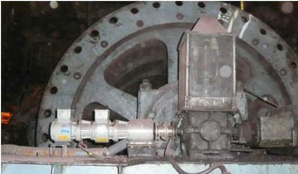
Fabricación de acero / Skip car: bloque de rodamientos con encoder incremental FG 40 y encoder absoluto AMS (interfaz SSI) Steel making / Skip car: bearing block with incremental encoder FG 40 and absolute encoder AMS (SSI interface)
