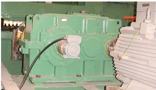
Trenes de laminación calientes / guías laterales: encoder absoluto AMS (interfaz SSI) Hot rolling mill / Side guides: absolute encoder AMS (SSI interface)
