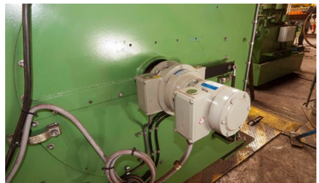
Warmwalzwerk / Hauptantrieb: Absolutwert-Drehgeber (Hohlwelle) ASPAH 60 (Parallel-Schnittstelle) mit elektronischem Grenzdrehzahl-Schalter EGS 40
