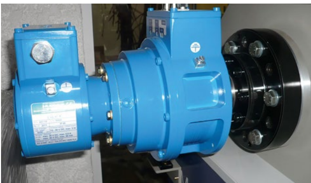
Walzwerk / Hauptantrieb: Absolutwert-Drehgeber (Hohlwelle) ASEH 60 (EtherCAT-Schnittstelle) mit angebautes Grenzdrehzahlschalter EGS 41 Rolling mill / Main drive: hollow shaft absolute encoder ASEH 60 (EtherCAT interface) and attached electronic overspeed switch EGS 41
