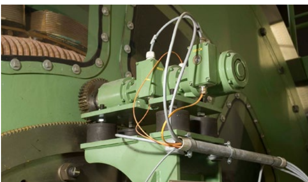
Bergbau / Fördermaschine: Lagerbock mit redundantem inkrementalen Drehgeber FG 40 KK und Absolutwert-Drehgeber AMN L (DeviceNet-Schnittstelle mit LWL-Anschluss) Mining / Winder: bearing block with redundant incremental encoder FG 40 KK and absolute encoder AMN L (DeviceNet interface with FOC connection)
