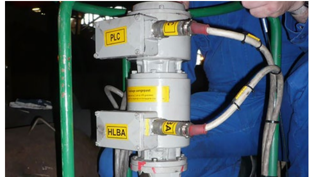
Walzwerk / Anstellungen: Absolutwert-Drehgeber AMSI (SSI-Schnittstelle und Inkrementalausgang) und angebautes Absolutwert-Drehgeber AMS (SSI-Schnittstelle) Rolling mill / Screw downs: absolute encoder AMSI (SSI interface and incremental output) and attached absolute encoder AMS (SSI interface)
