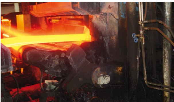
Warmwalzwerk / Looper: Absolutwert-Drehgeber ALS mit SSI-Schnittstelle in spezieller, robuster Looperausführung (u. a. Kugellager und Welle verstärkt)
