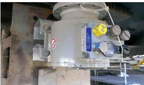
Bagger / Drehwerk: Absolutwert-Drehgeber AMPN 41 (PROFIsafe über PROFINET, SIL 3 / PL d)
