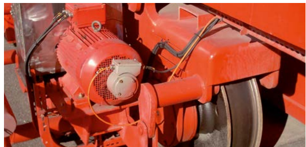
Инкрементальный энкодер FG(H) 40 L, установленные на двигателе Incremental encoder FG(H) 40 L mounted to the motor
