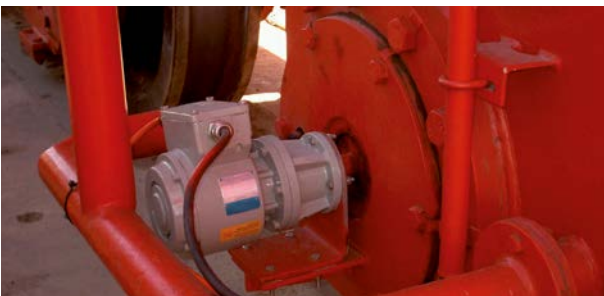
Базовое устройство U-ONE® для позиционирования; устанавливается на неприводное колесо / U-ONE® basic unit for positioning mounted to non-driven wheel
