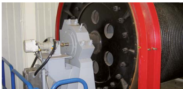
Базовое устройство U-ONE, многооборотное, с командоаппаратом с механическим редуктором / U-ONE® Multiturn basic unit with mechanical geared cam limit switch
