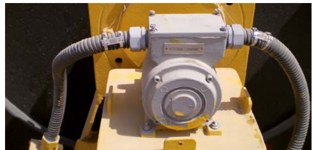
Базовое устройство U-ONE®, многооборотное, установленное на канатном барабане / U-ONE® Multiturn basic unit installed at rope drum
