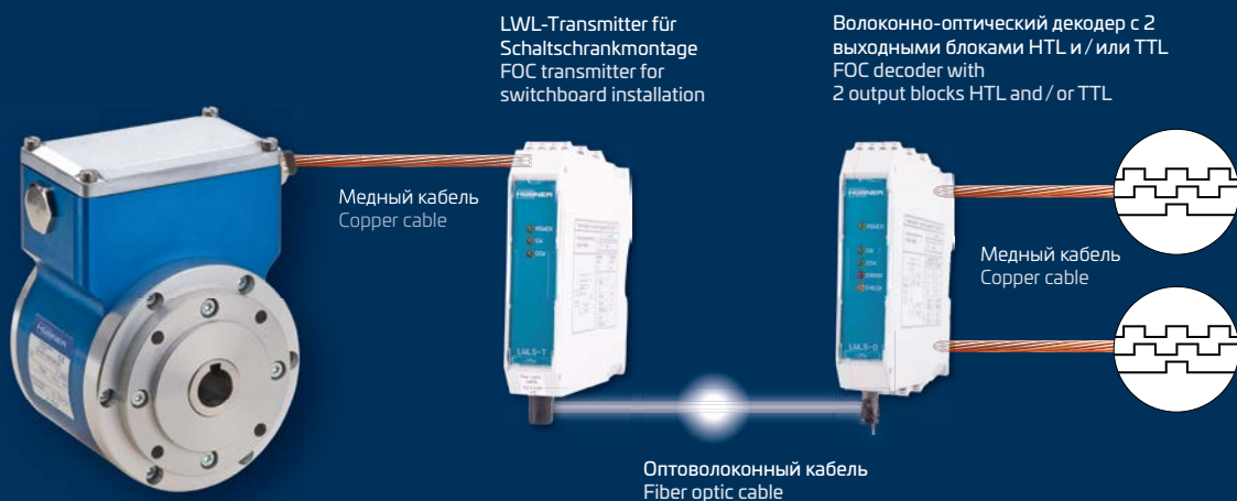
Энкодер с внешним передатчиком FOC Encoder with separate FOC transmitter
