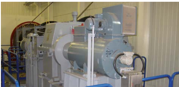
Двигатель с установленным инкрементальным энкодером FG(H) 40 L Motor with mounted incremental encoder FG(H) 40 L
