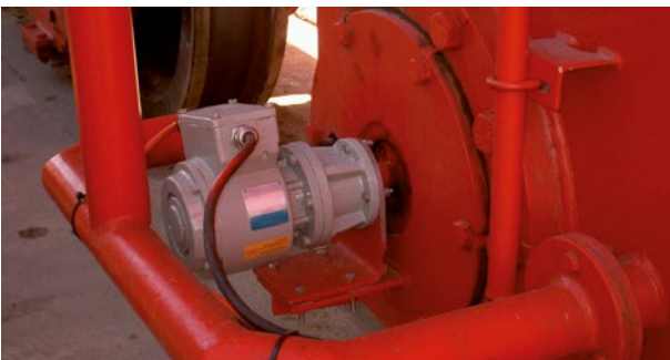
Unidade básica U-ONE® para posicionamento instalado em roda não tracionada / U-ONE® basic unit for positioning mounted to non-driven wheel
