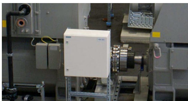
Нет свободного конца вала у вала между тандем двигателями No free shaft end at connection shaft between tandem motors
