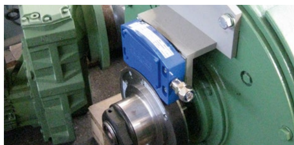
Система MAG без подшипников имеет увеличенный срок службы по сравнению со стандартными энкодерами / The bearing-free MAG system has an extended lifetime compared to standard encoders
