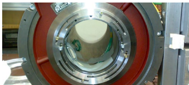
После: Точные сигналы благодаря непосредственному монтажу системы MAG, выполненной под заказ в корпусе двигателя / After: Precise signals through direct mounting of the customized MAG system in the motor housing
