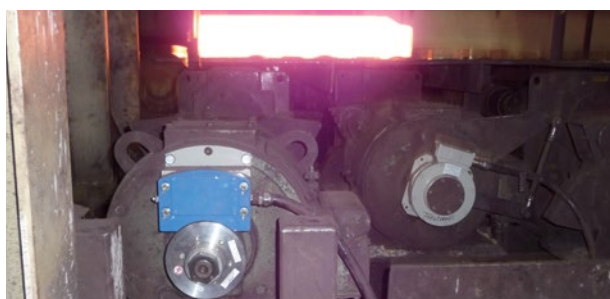
Двигатели роликового стола подвержены высоким ударным и вибрационным нагрузкам / Roller table motors are exposed to high shock and vibration loads
