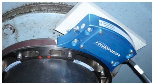
Решение с разъемным магнитным кольцом без демонтажа установки / Realization with split pulse wheel without dismantling of installation
