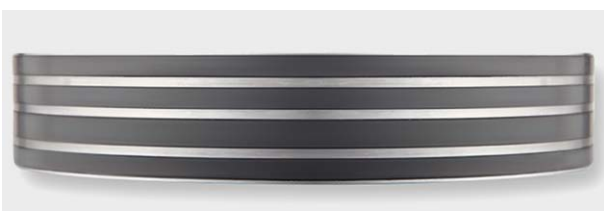
Rueda magnética de cuatro canales para señales de valor absoluto e incrementales con pulsación de referencia adicional
