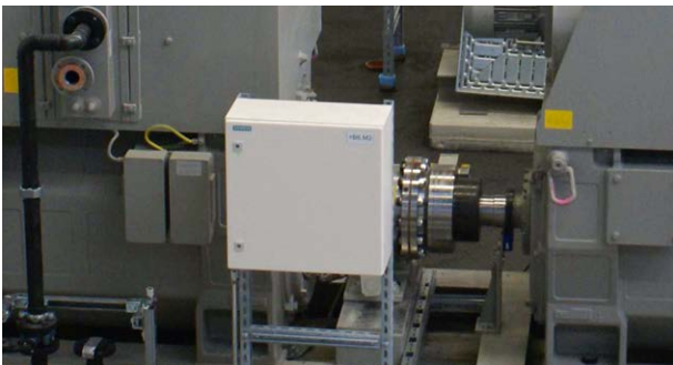
Ningún extremo de eje libre en el eje de conexión entre los motores tándem No free shaft end at connection shaft between tandem motors
