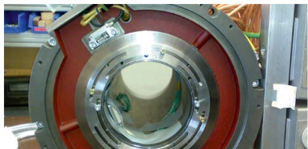
Nachher: Präzise Signale durch Direktanbau des maßgeschneiderten MAG-Systems im Motorenhäuser/After: Precise signals through direct mounting of the customized MAG system in the motor housing
