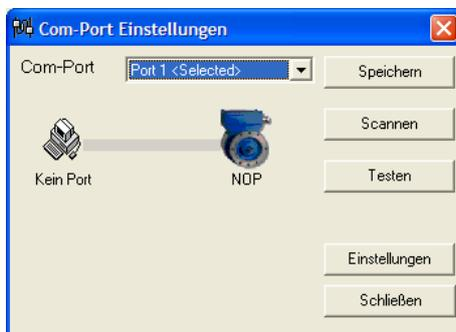
Wenn Sie nicht genau wissen, welchen Com-Port der PC ihrem „USB Serial Device“ zugewiesen hat, können Sie mit „Scannen“ das Gerät finden. Dafür muss das Gerät an Betriebsspannung angeschlossen sein. Standardmäßig werden max. 9 Com-Port untersucht, sollte der Com-Port höher liegen, müssen Sie es unter „Einstellungen“ anpassen.
