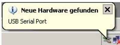
Danach muss der USB Serial Port“-Treiber installiert werden. Auch dieser sollte automatisch den Assistenten starten.
