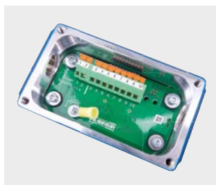
Regleta de terminales en la caja de terminales / Terminal strip in a terminal box
