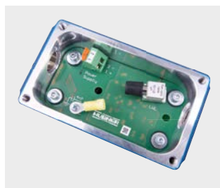
Enchufe FO en la caja de terminales / FOC connector in a terminal box
