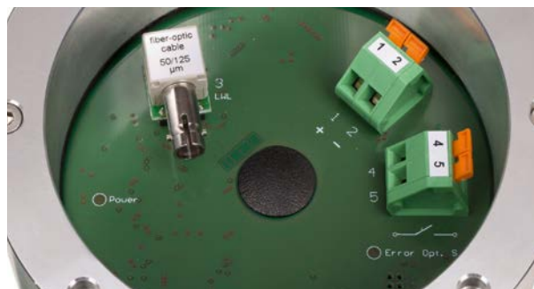
Klemmkasten Option LWL (Signalübertragung über Lichtwellenleiter) Terminal box option FOC (signal transmission via fiber optic cable)
