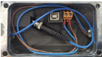
Abbildung: LWL-Kabel und Versorgungskabel im Klemmkasten des FGH 40
