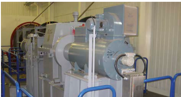
Motor mit angebaurem inkrementalem Drehgeber FG(H) 40 L Motor with mounted incremental encoder FG(H) 40 L
