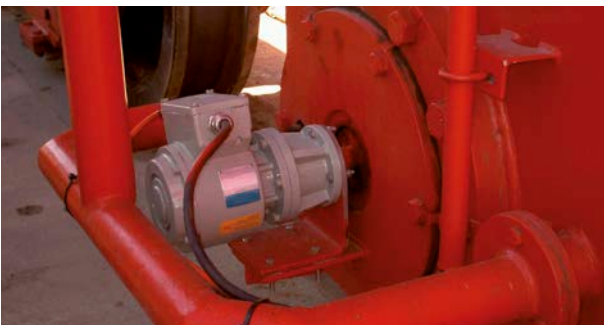
U-ONE® Basisgerät zur Positionierung angebau am nicht angetriebenen Rad U-ONE® basic unit for positioning mounted to non-driven wheel
