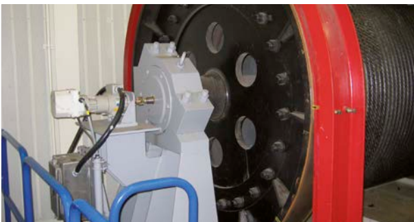
U-ONE® Multiturn Basisgerät mit mechanischem Getriebe-Nockenendschalter U-ONE® Multiturn basic unit with mechanical geared cam limit switch
