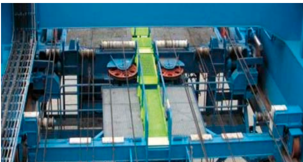
Katzfahrwerk mit Seilzugantrieb Trolley with rope winch drive
