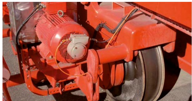
Inkrementaler Drehgeber FG(H) 40 L montiert am Motor Incremental encoder FG(H) 40 L mounted to the motor
