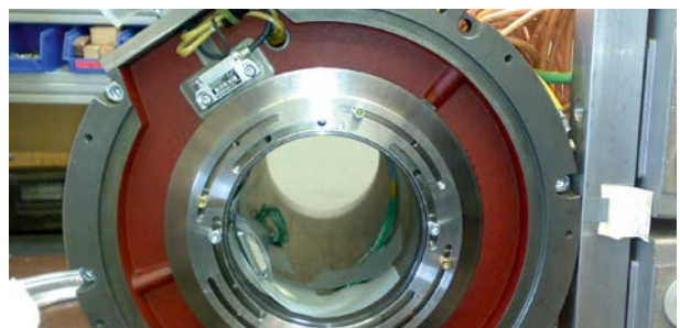
Nachher: Präzise Signale durch Direktanbau des maßgeschneiderten MAG-Systems im Motorenhäule/After: Precise signals through direct mounting of the customized MAG system in the motor housing
