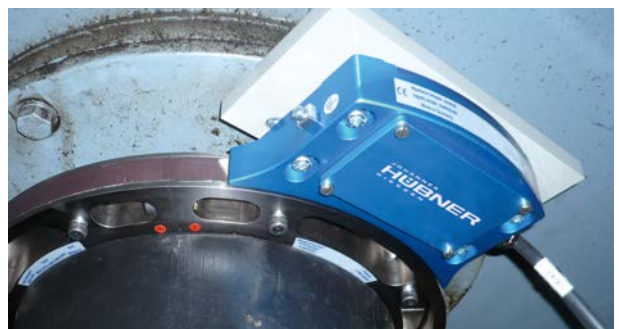
Realisierung mit geteiltem Polrad ohne Anlagendemontage Realization with split pulse wheel without dismantling of installation
