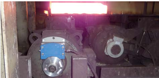
Rollgangsmotoren sind extremen Schock- und Vibrationsbelastungen ausgesetzt/Roller table motors are exposed to high shock and vibration loads
