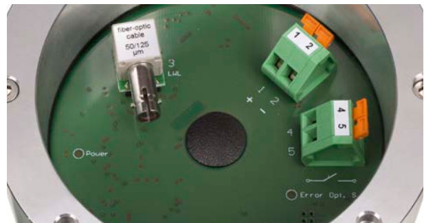
Klemmkasten Option LWL (Signalübertragung über Lichtwellenleiter) Terminal box option FOC (signal transmission via fiber optic cable)
