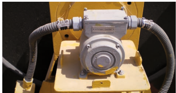
安装在卷筒上的 U-ONE® 多圈基本单元 U-ONE® Multiturn basic unit installed at rope drum
