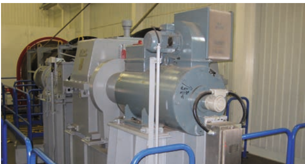
安装在电机上的增量编码器 FG(H) 40 L Motor with mounted incremental encoder FG(H) 40 L
