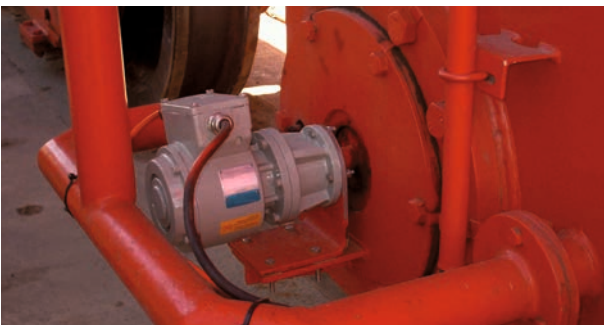
安装在非传动轮上的位置检测的 U-ONE® 基本装置 U-ONE® basic unit for positioning mounted to non-driven wheel
