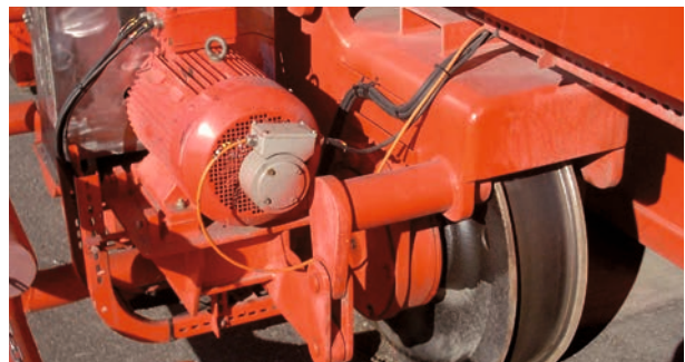
Encoder incremental FG(H) 40 L instalado en el motor Incremental encoder FG(H) 40 L mounted to the motor
