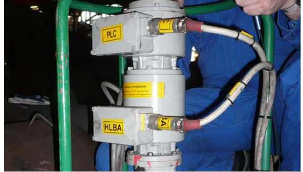
轧机 / 压下装置: 绝对值编码器 AMSI (SSI 接口和增量输出) 和附加的绝对值编码器 AMS (SSI 接口)
