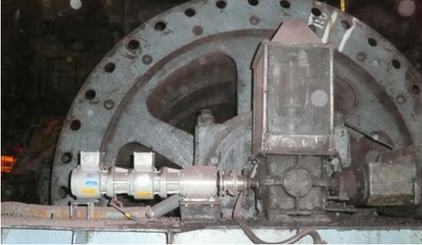
炼钢 / 翻斗车: 轴承座连接有 增量编码器 FG 40 和绝对编码器 AMS (SSI 接口)
