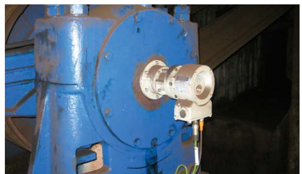
能源供应公司 / 压块机: 绝对值编码器 ASPN (接口 PROFINET IO) Energy supply company / Briquetting press: absolute encoder ASPN (interface PROFINET IO)
