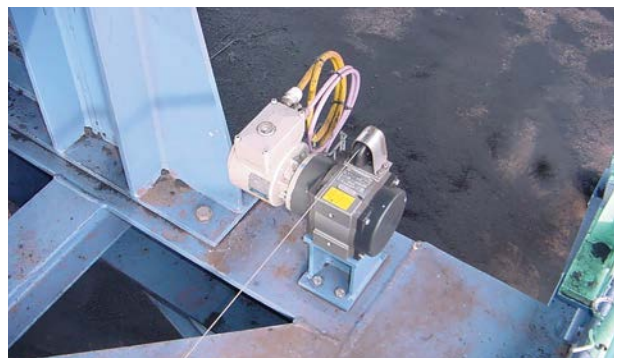
物料搬运 / 传送带: 带绝对值编码器 AMP (PROFIBUS 接口) 的绳长变送器
