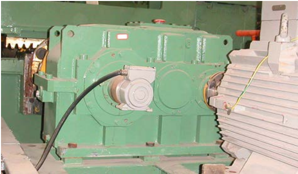
热轧 / 侧导板: 绝对值编码器 AMS (SSI 接口) Hot rolling mill / Side guides: absolute encoder AMS (SSI interface)
