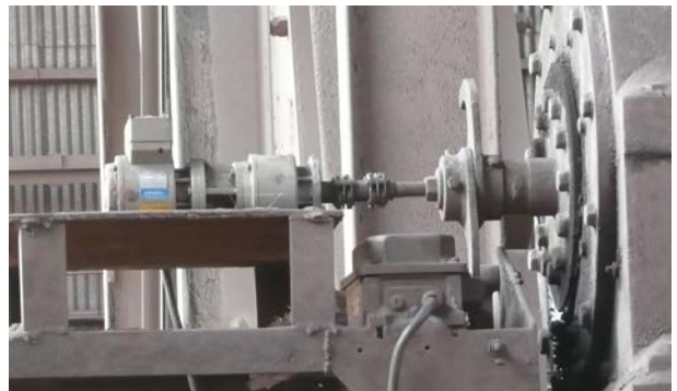
物料搬运 / 翻车机: 轴承座连接有 绝对值编码器 AMN (DeviceNet 接口)
