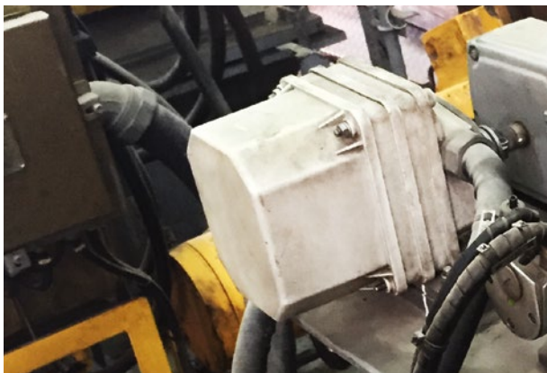
Vorher: Mechanisches Kopierwerk. Before: Mechanical cam limit switch.
