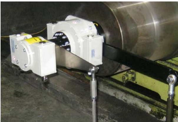
Anbau von FGH 6 mit EGS 4 über Flansch-Adapterwelle und Drehmomentstützen.
