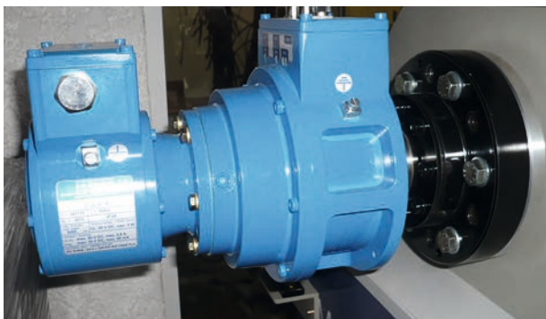
Walzwerk / Hauptantrieb: Absolutwert-Drehgeber (Hohlwelle) ASEH 60 (EtherCAT-Schnittstelle) mit angebautes Grenzdrehzahlsschalter EGS 41
