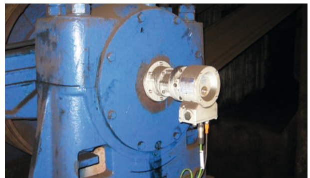
Energieversorgungsunternehmen / Briquettpresse: Absolutwert-Drehgeber ASPN (Schnittstelle PROFINET IO) Energy supply company / Briquetting press: absolute encoder ASPN (interface PROFINET IO)
