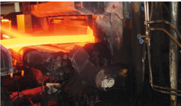
Warmwalzwerk / Looper: Absolutwert-Drehgeber ALS mit SSI-Schnittstelle in spezieller, robuster Looperausführung (u. a. Kugellager und Welle verstärkt) Hot rolling mill / Looper: absolute encoder ALS with SSI interface in special robust looper design (e. g. bearings and shaft reinforced)
