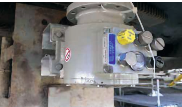
Bagger / Drehwerk: Absolutwert-Drehgeber AMPN 41 (PROFIsafe über PROFINET, SIL 3 / PL d) Excavator / Slewing gear: absolute encoder AMPN 41 (PROFIsafe via PROFINET, SIL 3 / PL d)
