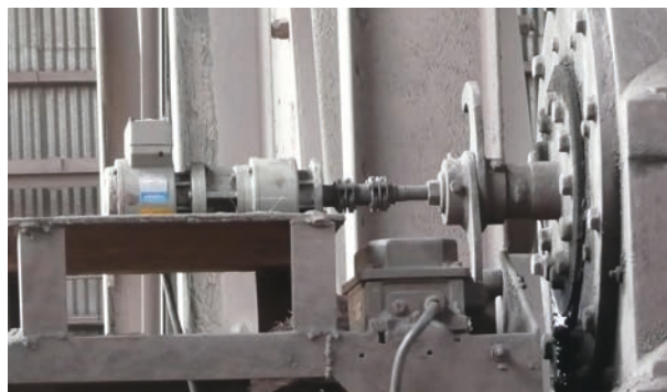
Materialtransport / Waggonkipper: Lagerbock mit angebautes Absolutwert-Drehgeber AMN (DeviceNet-Schnittstelle)
