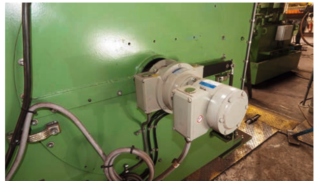
Warmwalzwerk / Hauptantrieb: Absolutwert-Drehgeber (Hohlwelle) ASPAH 60 (Parallel-Schnittstelle) mit elektronischem Grenzdrehzahl-schalter EGS 40 Hot rolling mill / Main drive: hollow shaft absolute encoder ASPAH 60 (parallel interface) with attached electronic overspeed switch EGS 40
