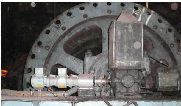
Stahlerzeugung / Skip Car: Lagerbock mit inkrementalem Drehgeber FG 40 und Absolutwert-Drehgeber AMS (SSI-Schnittstelle)
